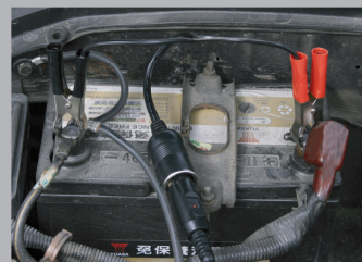
★ 電瓶夾連接汽車電瓶使用 (DC-12V 用)
