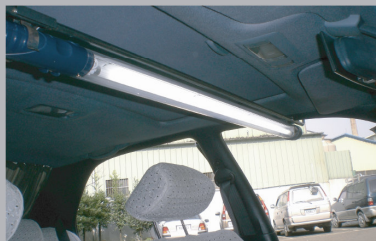
★ 配合 T5 工作燈引擎蓋夾持座，可使用於引擎蓋夾持 (YTT5-21W 用)
